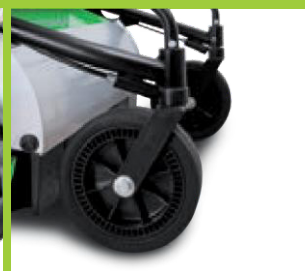
Bloccaggio ruote anteriori (accessorio) rapido con comando a console Front wheels brake (implement) easy to use
