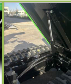
Pistone ribaltamento con valvola di blocco Tipping cylinder with check valve
