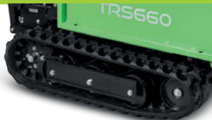
Carro TRS660 con scivolo anteriore. Rulli con cuscinetti doppia tenuta stagna Chassis TRS660 with front slide. Rollers with double sealed bearings
