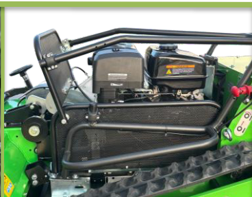
Griglia di protezione anti-intasamento per il raffreddamento del motore Engine Cooling Anti-Clog Protection Grille
