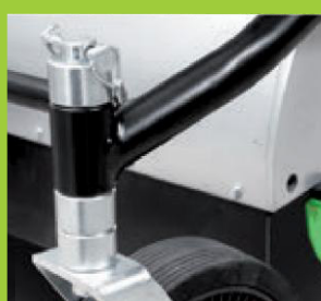
Asse ruote con sbloccaggi indipendenti Sistema regolazione taglio (accessorio) Height cutting adjustment Wheel axle Independent releases (implement)
