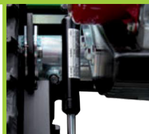
Cingolo autoregolato con molle indipendenti Track with independent springs
