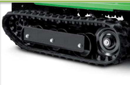
Carro rinforzato con rulli montati su doppio cuscinetto Reinforced chassis, Rollers with double sealed bearings
