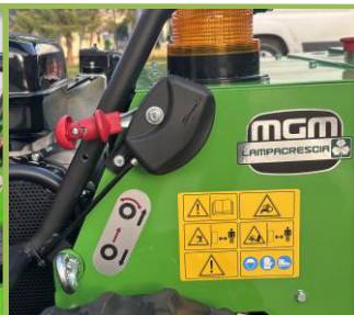
Dispositivi di bloccaggio ruote anteriori e punti di sollevamento/ancoraggio macchina Front Wheel Locking Devices and Machine Lifting/Anchoring Points
