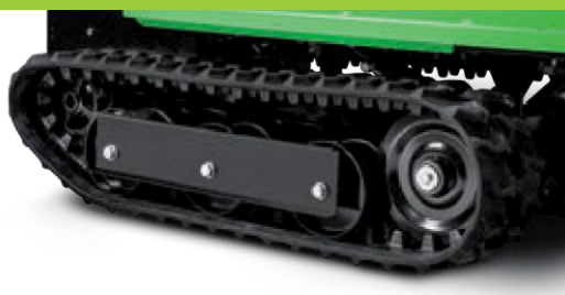
Carro rinforzato con rulli montati su doppio cuscinetto Reinforced chassis Rollers with double sealed bearings
