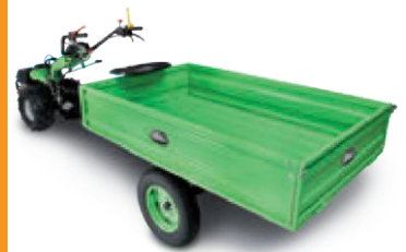
Rimorchio ribaltabile con freni (accessorio) Tip-up trailer with brakes (implement)
