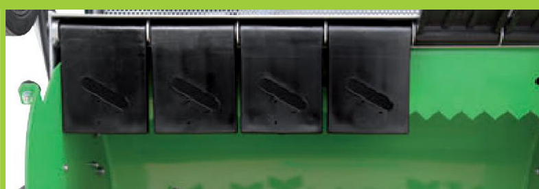
Gruppo di taglio con controcoltello e bandelle oscillanti Cutting unit with oscillating safety protections and bottom blade
