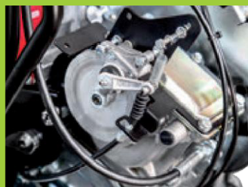
Freno a disco sincronizzato con comando frizione Disc brake synchronized with clutch lever
