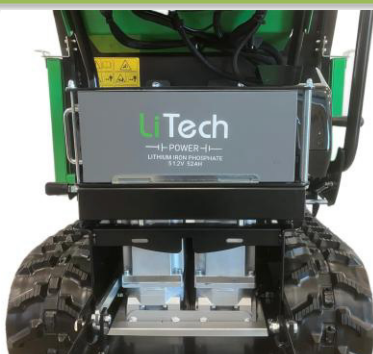
N.2 motori elettrici 1,5 Kw Batteria 48V 52Ah LFP 2 x 1.5 kW Electric Motors with 48 V 52 Ah LFP Battery
