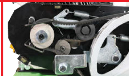
Sistema inversione marcia: con motore bialbero. Reverse gear system: double shaft engine.
