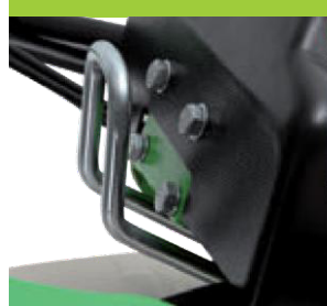
Sistema rapido orientamento stegola regolabile in altezza e lateralmente Quick release height and side adjustable handlabars
